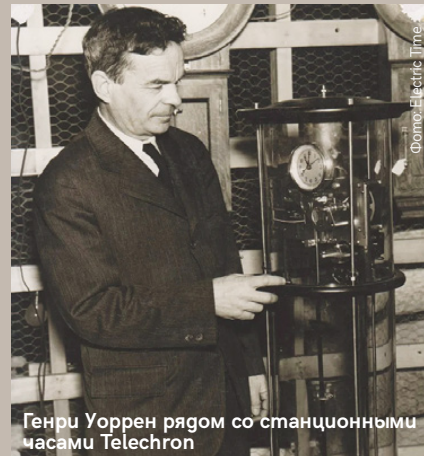
Первичные станционные часы Telechron типа «В»
