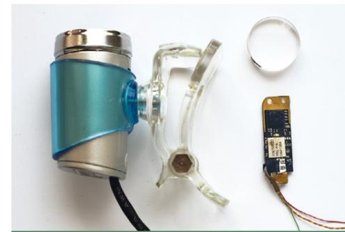
**ШАГ 1.** Разобудьте web-камеру, по возможности небольших размеров, для мощного паяльника или встроенную камеру от ноутбука для маломощного. Также вам понадобятся линзы – несколько штук на выбор.
