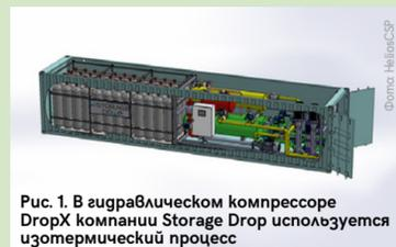
Рис. 1. В гидравлическом компрессоре DtopX компании Storage Dtop используется изотермический процесс
