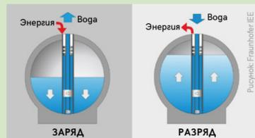
Рис. 2. Схема работы накопителя StEnSea
