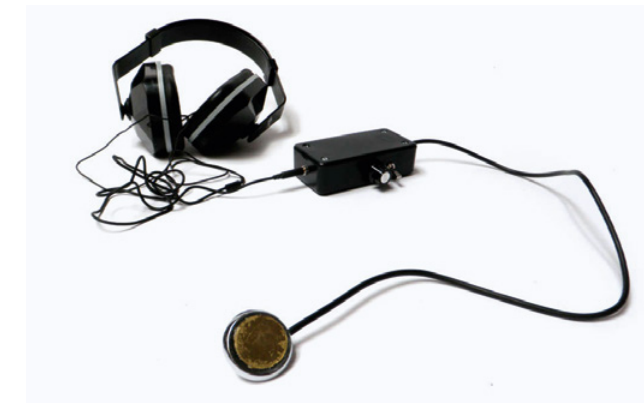
ШАГ 4. Спаяйте уже настроенную схему на миниатюрной печатной плате. Изготовьте для неё корпус, который может быть отдельным или совмещённым с головкой стетоскопа. Желаем удачи! ЭВ
